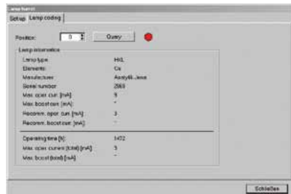
Display of coded lamp parameters
